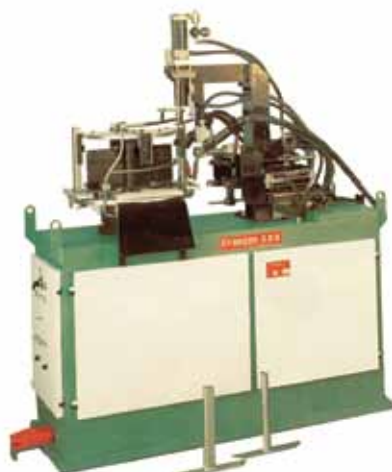
Saldatrice di testa per profilati Butt welder for metallic sections
