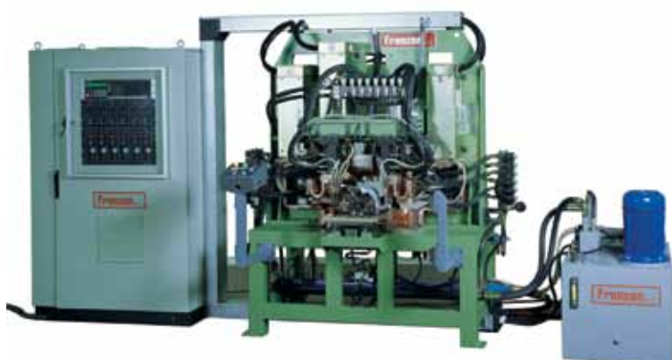
Saldatrice a punti multipli idraulica particolari auto Hydraulic multiple spot welder for car parts
