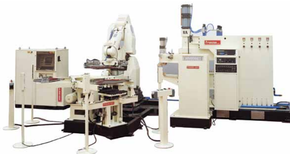
Isola robotizzata automatica per griglie Automatic robotized island for grills
