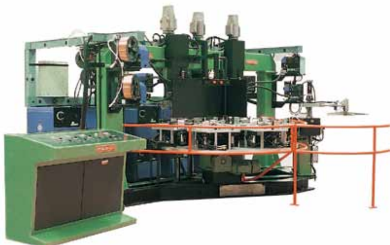
Impianto automatico di saldatura MIG per basi sedie dattilo Automatic MIG welding installation for typewriting chair bases
