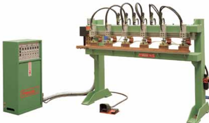
Portale con unità flessibili Bridge welder with flexible units
