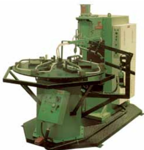
Saldatrice a proiezione con tavola rotante. Scarico automatico. Projection welding machine with rotating table. Automatic unloading.
