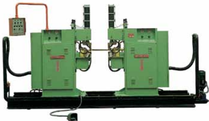
Complesso di saldatrici affiancate particolari riscaldamento Assembly of welding machine facing each other for heating parts
