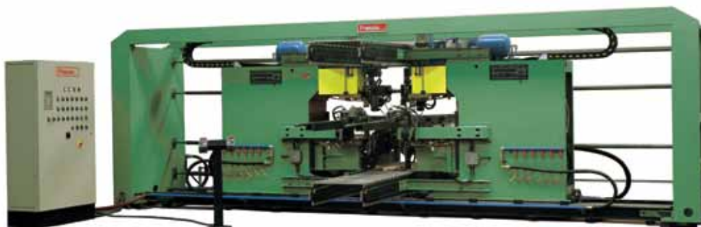
Saldatrice automatica per assemblare radiatori tubolari Automatic welding machine to assemble tubular radiators
