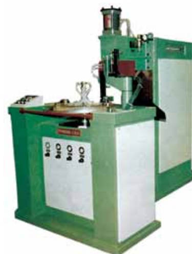
Saldatrice a proiezione con tavola rotante particolari auto Projection welding machine with rotating table for car parts
