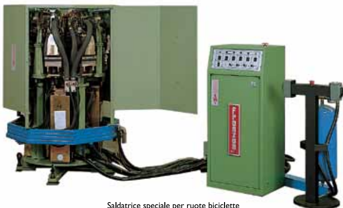
Saldatrice speciale per ruote biciclette Special welding machine for bike wheels
