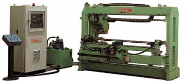
Saldatrice a portale idraulica con CNC Hydraulic bridge welder with CNC
