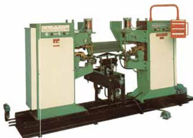
Saldatrice a proiezione per particolari su profilati Projection welding machine for parts on metal sections
