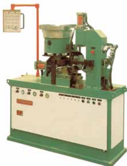
Saldatrice con alimentazione particolari Welding machine with piece feed
