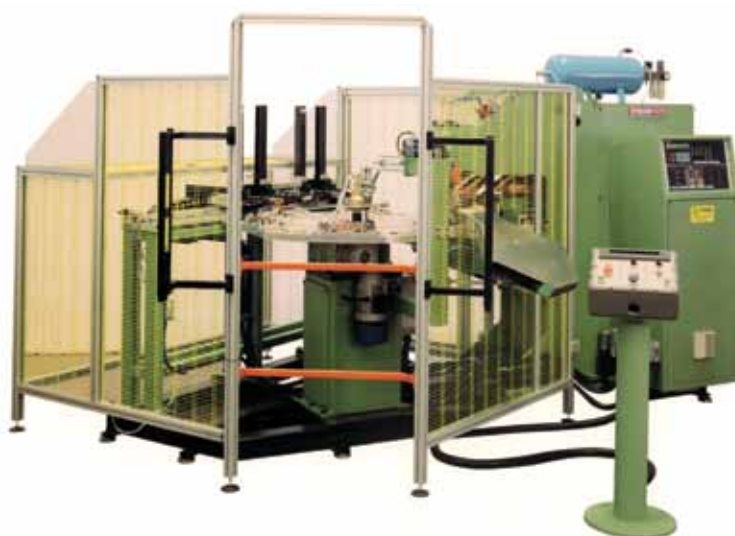
Isola automatica di saldatura componenti di elettrodomestici Automatic welding island for household appliance components
