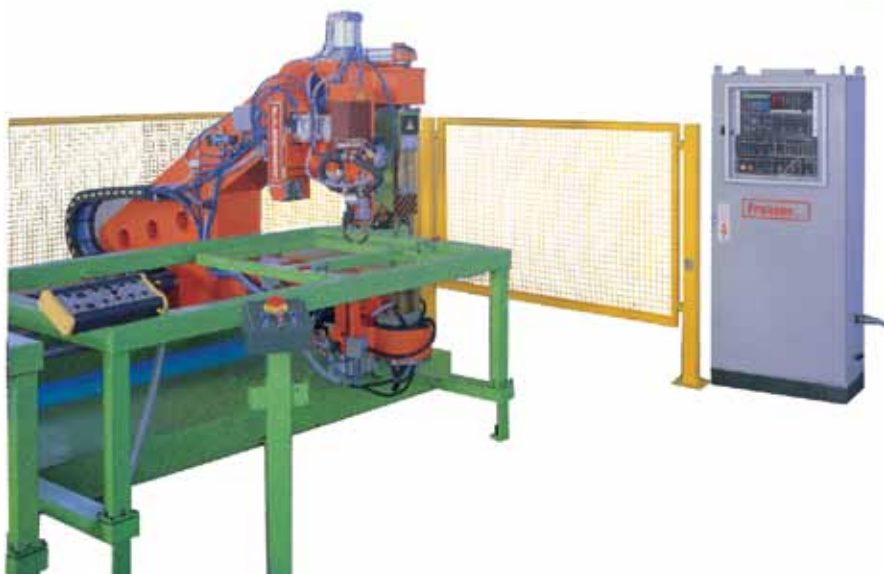
Manipolatore assi cartesiani per saldatura componenti metallici Cartesian axis mechanical hand for metallic part welding
