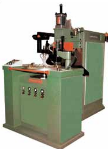
Saldatrice a proiezione con tavola rotante e scarico automatico dei particolari auto Projection welding machine with rotating table and automatic unloading of car parts
