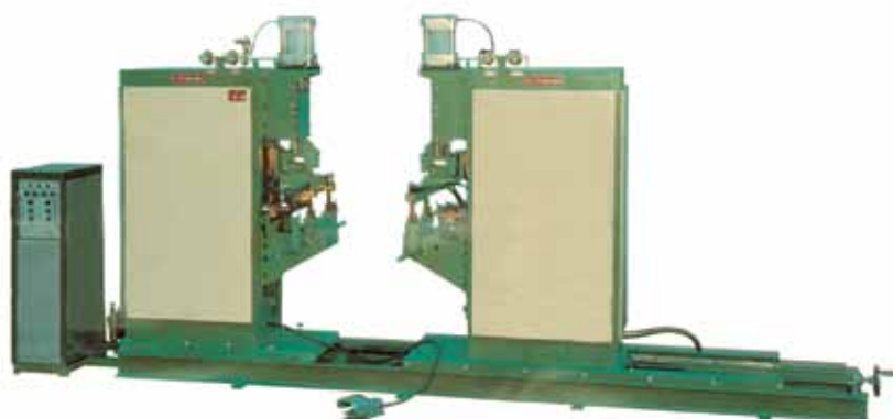
Saldatrici a proiezione affacciate regolabili Adjustable projection welding machines facing each other
