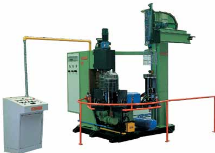
Saldatrice con elettrodi rotativi e tavola rotante. Scarico automatico Welding machine with rotating electrodes and rotating table. Automatic unloading
