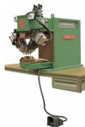
Saldatrice da banco per astucci occhiali Bench welding machine for glasses cases
