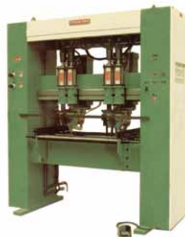
Portale con unità di saldatura flessibile Bridge machine with flexible welding unit
