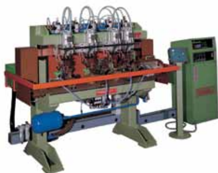
Complesso di unità di saldatura automatico per elettrodomestici Automatic assembly of welding units for household appliances
