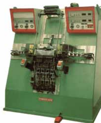
Saldatrice a punti per componenti sedie Spot welding machine for chair parts
