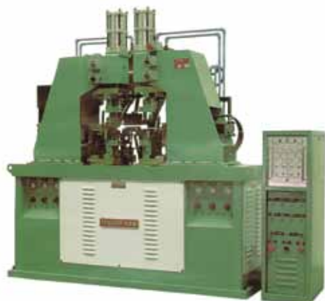
Saldatrice a ricalco per tondi pieni Upset welding machine for solid rods
