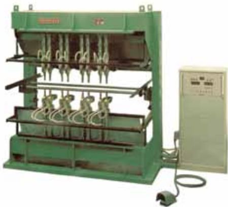
Saldatrice a punti multipli con unità regolabili Multiple spot welder with adjustable units
