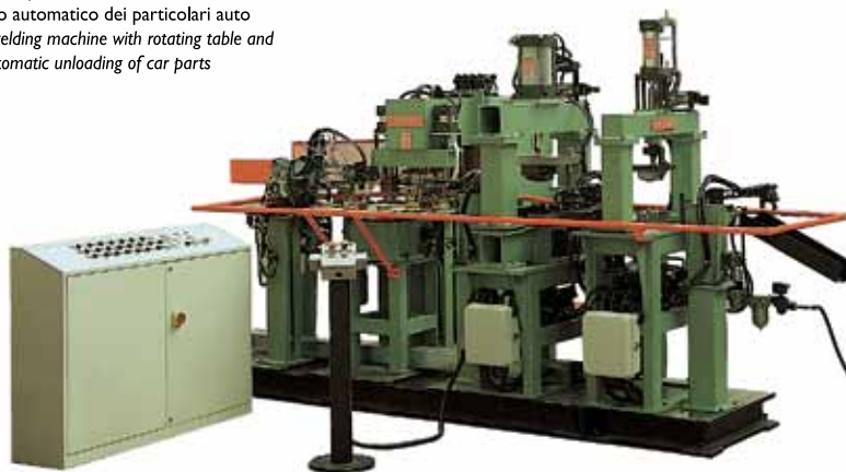
Isola di saldatura con maschera di piegatura e tranciatura del particolare Welding island with jig for folding and blanking the piece
