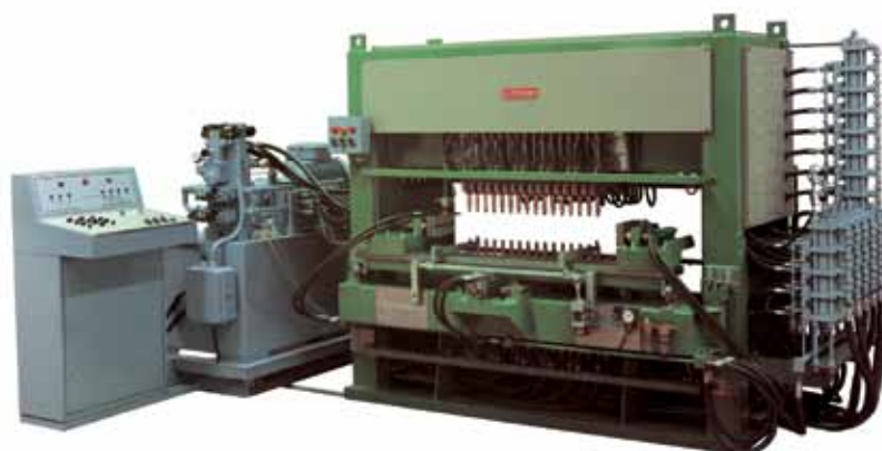
Saldatrice a punti multipli idraulica Hydraulic multiple spot welder
