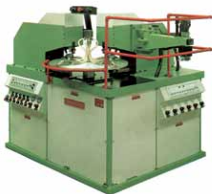
Saldatrici a proiezione con tavola rotante per particolari auto con scarico automatico Projection welding machines with rotating table and automatic unloading for car pieces
