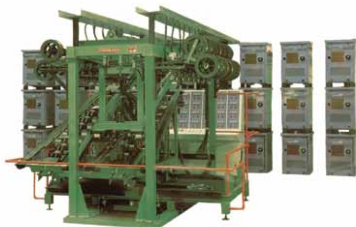
Isola di saldatura automatica scale Automatic welding island for ladders
