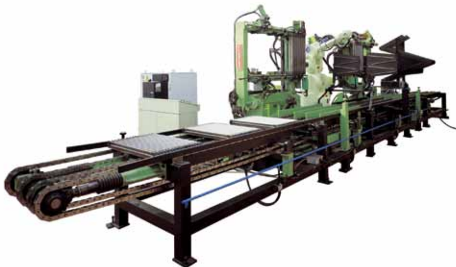
Complesso automatico saldatura boccola su radiatori lamellari Automatic assembly for bush welding on finned radiators
