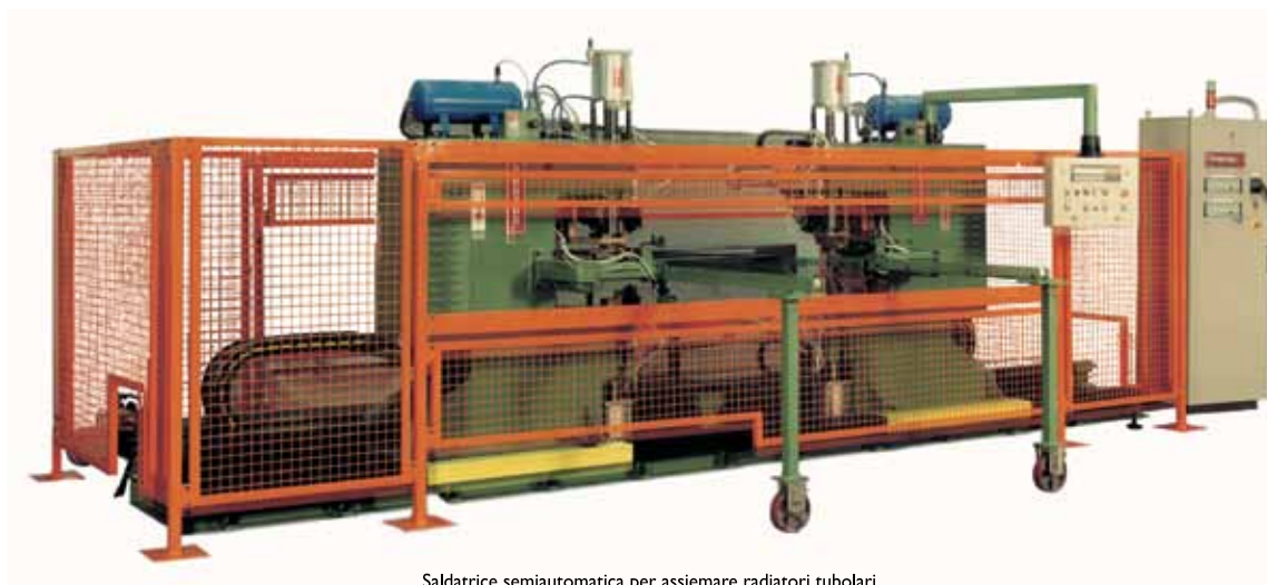
Saldatrice semiautomatica per assemblare radiatori tubolari Semiautomatic welding machine to assemble tubular radiators
