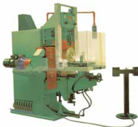
Saldatrice a elettrodi rotativi con attrezzatura speciale Rotating electrode welder with special equipment
