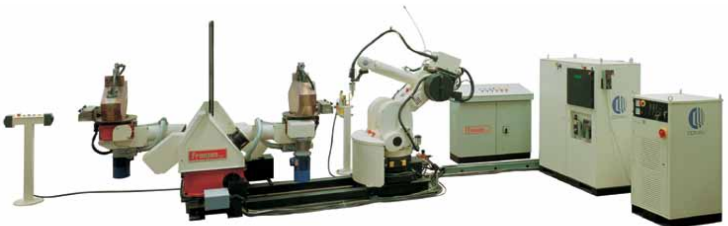
Isola robotizzata con tavola e controllo numerico 11 assi interpolati Robotized island with table and numeric control, 11 interpolated axes
