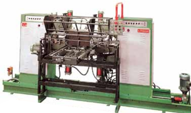
Saldatrice a proiezione automatica particolari stendibiancheria Automatic projection welder for laundry rack pieces
