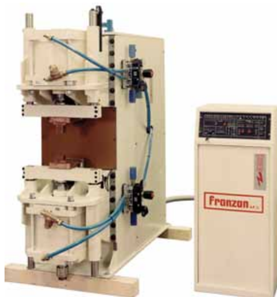
Saldatrice ricalcatrice per tubi Upsetting welding machine for pipes
